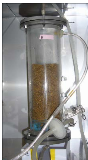
図 4-1-2. ラボスケール脱臭試験装置のロックウール脱臭担体充填部 (図 4-1-1 の (6)).
