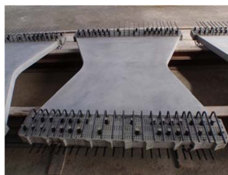
図-7.11. 製作されたバタフライウェブ
