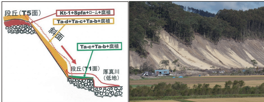
図17 吉野地区の崩壊のイメージ(断面)と崩壊地の写真
