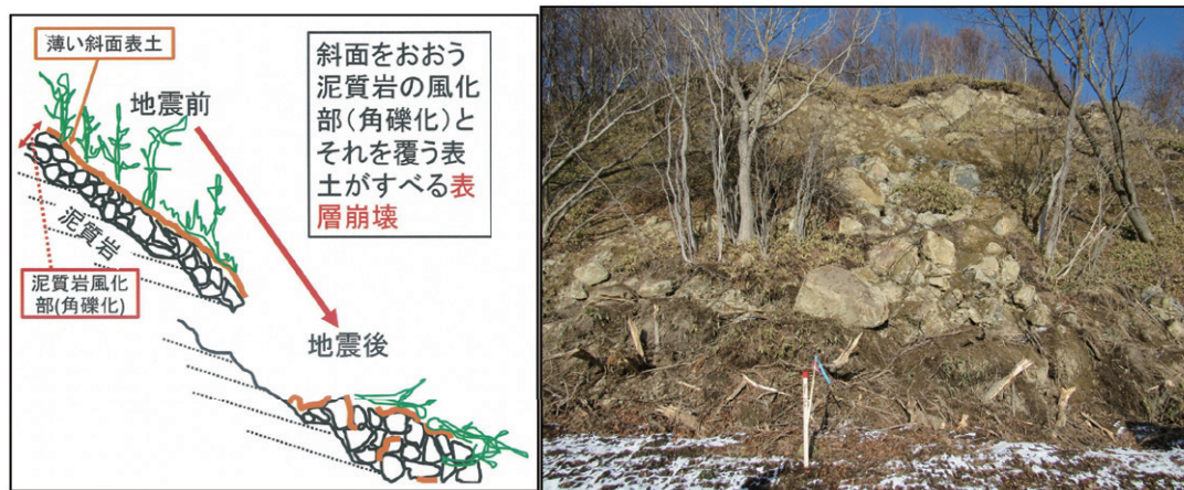
図13 新第三系泥質岩の風化部の表層崩壊のイメージと露頭写真(むかわ町春日一区用水路沿い)
