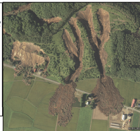
図10 幌内北西で見られる平滑型斜面での崩壊(左: 924-05地点)と沢単位での崩壊・地すべり(右: 924-06地点). 図10・11国土地理院2018.9.6撮影空中写真「厚真川地区」使用。
