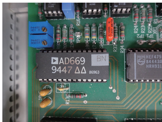
写真2 高電圧制御ボードの一部と茶色に焦げたIC(IC3-AD669-BN)
