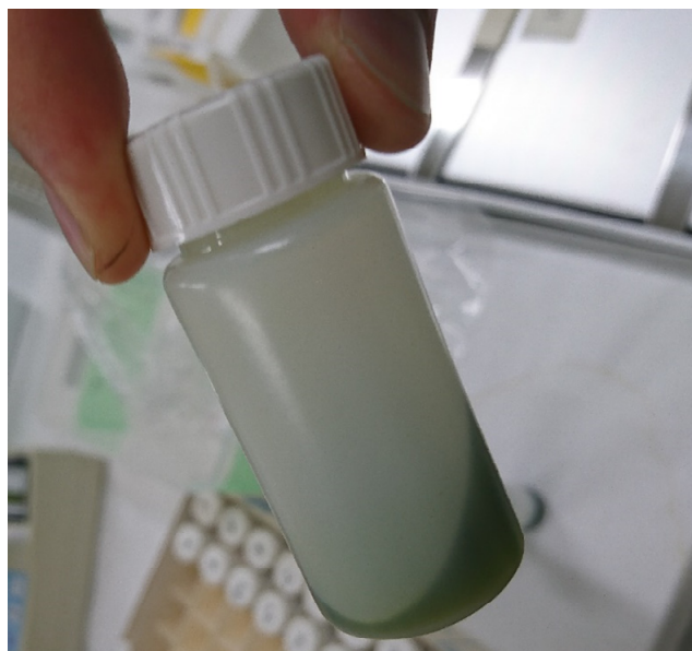
Fig. 2-1 液体シンチレーションカクテルの着色 (植物葉試料)
