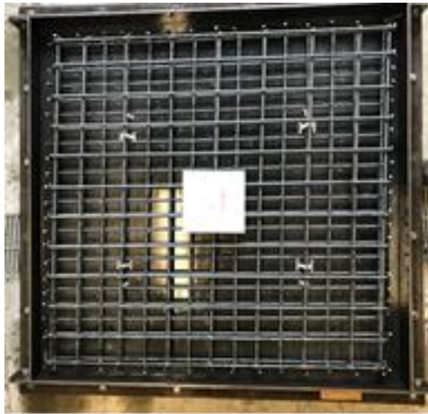
図-4.16 模擬水平ひび割れの導入方法
