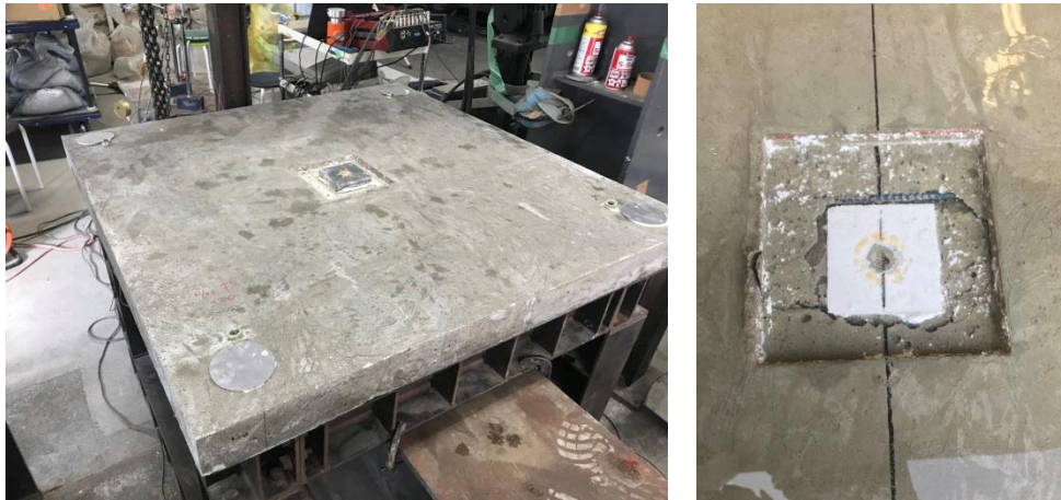
図-4.21 かぶりコンクリートのない R200 供試体
