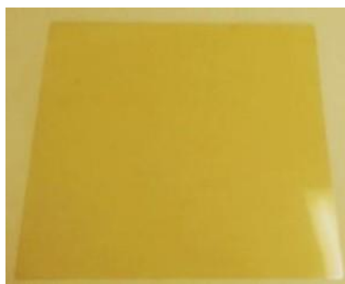
図 2-1 20 \mu\text{m} 厚の ZS-100 フィルムを両面にラミネートした 100 \mu\text{m} 厚の EN-A1 ガラス
