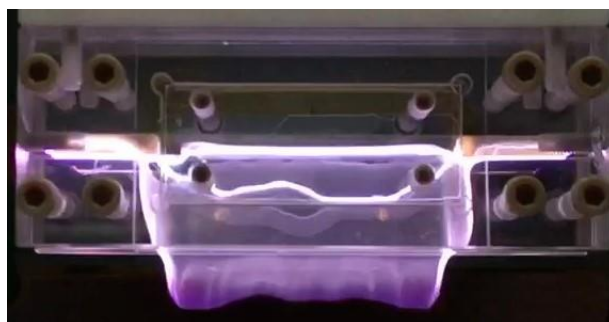
図 4-7 TGV の無いガラスを内壁に用いた際の放電の様子 (デジタルカメラ (iPhone6s、F2.2、露光時間 30 ms) で撮影)
