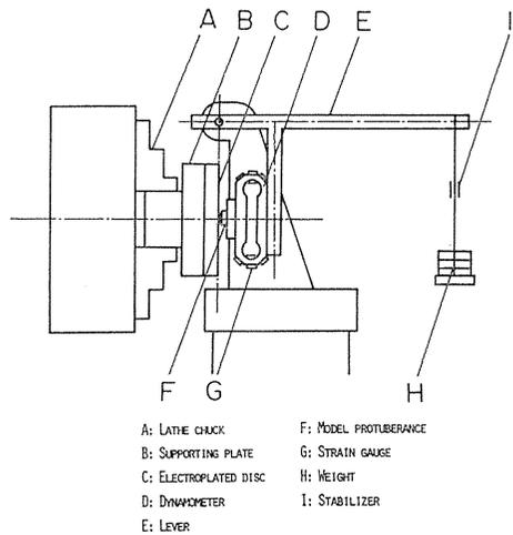
Fig. 3. Experimental apparatus.
