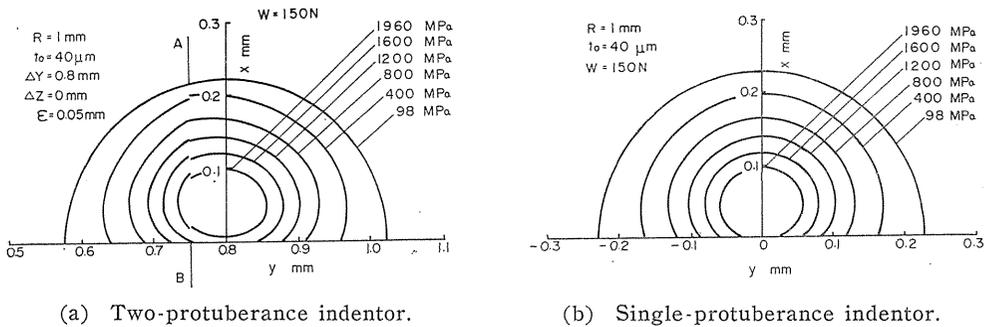
Fig. 42. Contact pressure distribution ( $W=150 \text{ N}$ ).
