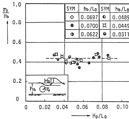
Fig. 18. Radius of horizontal roller.
