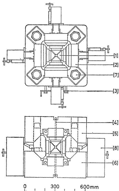
Fig. 3. Cubic anvil apparatus.
