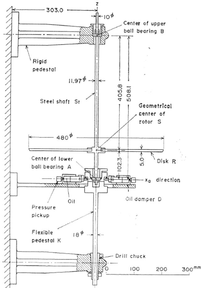
Fig. 8. Experimental apparatus.
