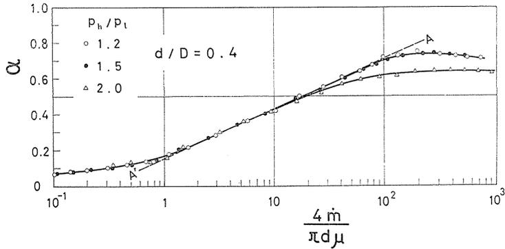
FIG. 10-a. Discharge coefficient ( $d/D=0.4$ ).
