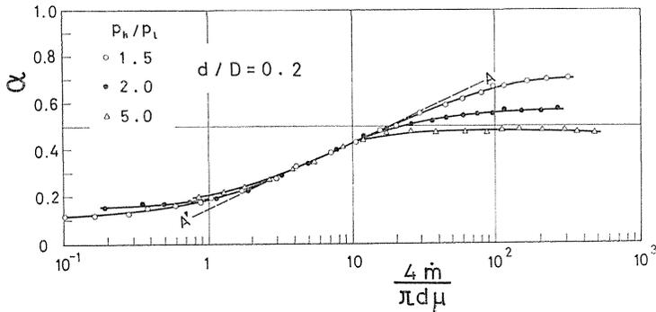
FIG. 10-b. Discharge coefficient ( $d/D=0.2$ ).
