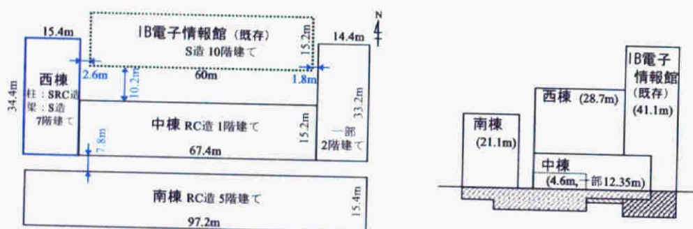
図 2.18 増築後の S 造建物の平面図（左）と東立面図（右）
