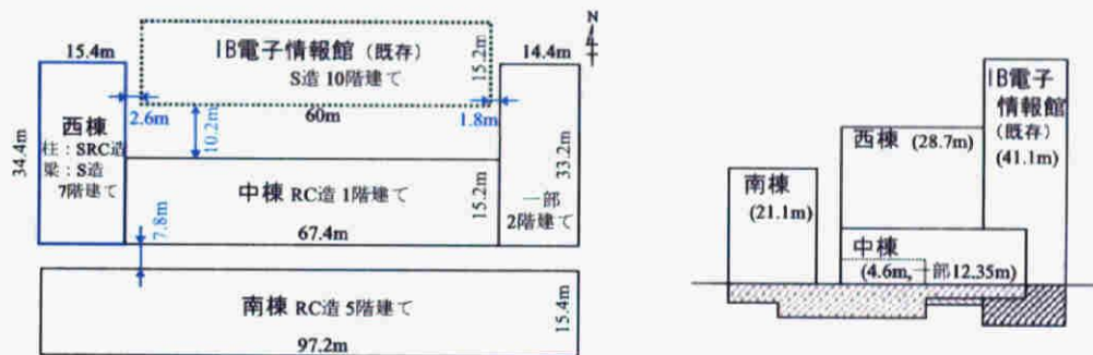
図 3.20 増築後の S 造建物の平面図（左）と東立面図（右）
