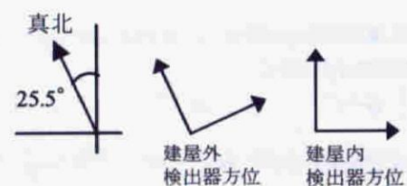
図 2.36 強震計の設置方位
