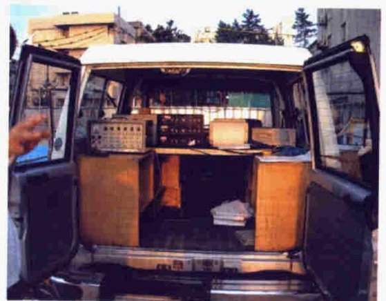
図 2.10 計測車をステーションとした時の様子
