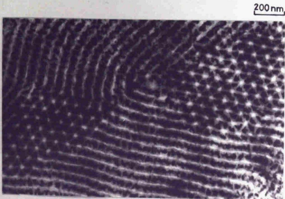
図15 三元ブロック共重合体SAI-1の電子顕微鏡写真 キャスト溶媒:ベンゼン, 固定剤:オスミウム酸
