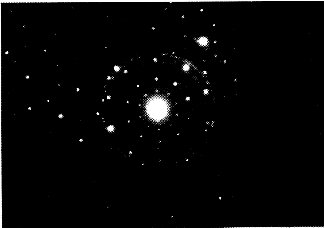
図 5.2 MA 粉の電子線回折スペクトル.
