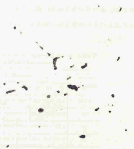
(d) \text{ZrS} ; Zr% in weld metal=0.4
