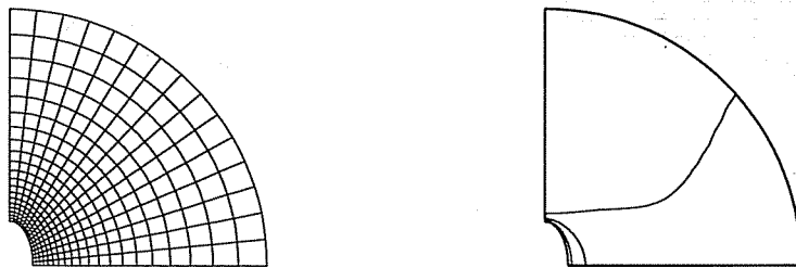
図6 孔の空いた無限平板の解析結果：要素分割(左) / ひずみエネルギー密度分布(右)
