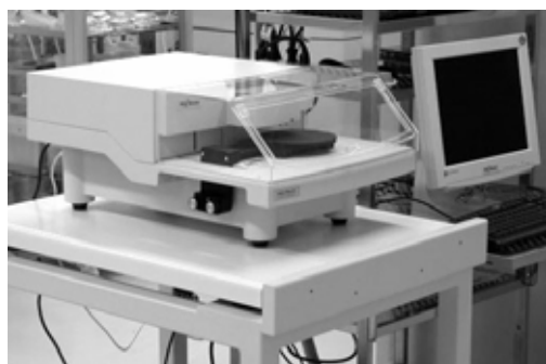
図2.29 触針式段差計の外観図。
