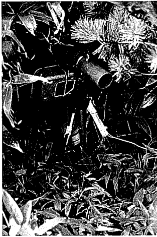
写真 3-2. 調査路脇に設置した自動撮影装置 防水ケースに入ったコンパクトカメラと赤外線センサー（塩ビパイプ内）から構成される。
