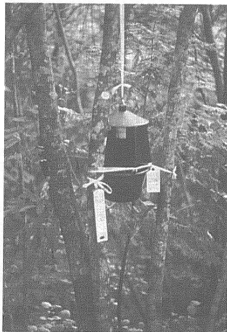
図1-2. キクイムシ飛翔成虫誘引トラップ(マダラコール)
