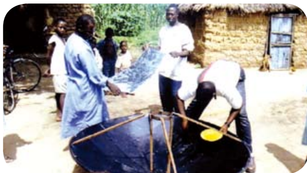
写真 9 太陽熱集積装置（ソーラー・クッカー）を作製中（反射面にアルミホイルを貼り付けている様子）
