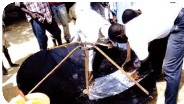
写真 9 太陽熱集積装置（ソーラー・クッカー）を作製中（反射面にアルミホイルを貼り付けている様子）
