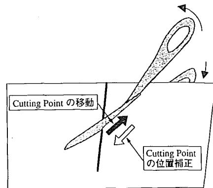
図 9 ハサミを開いたときの位置補正
