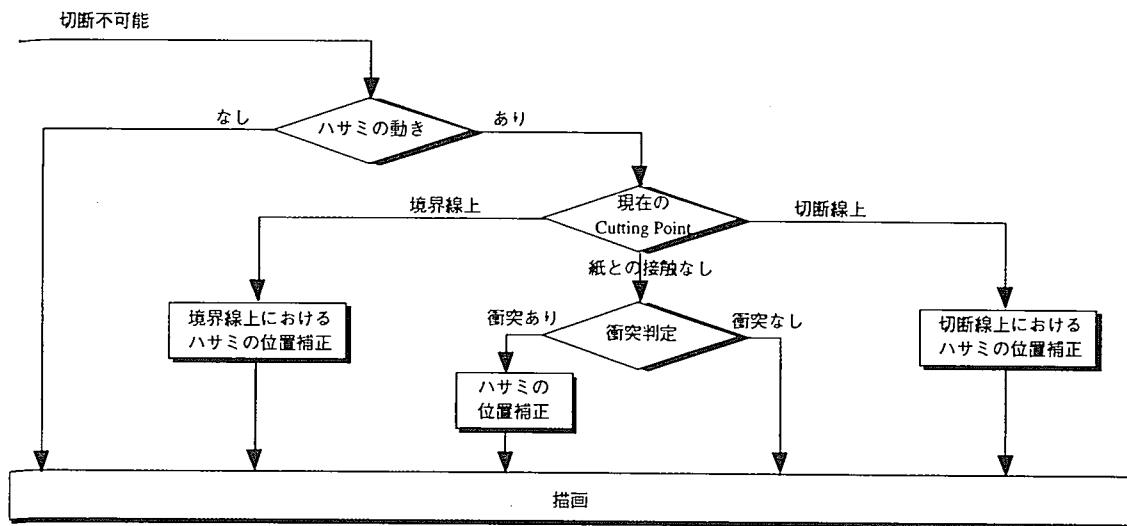
図 10 衝突判定および位置補正
