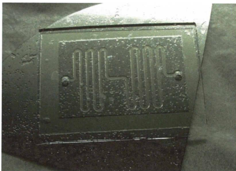
図16 パイレックスガラス陽極接合後の様子
