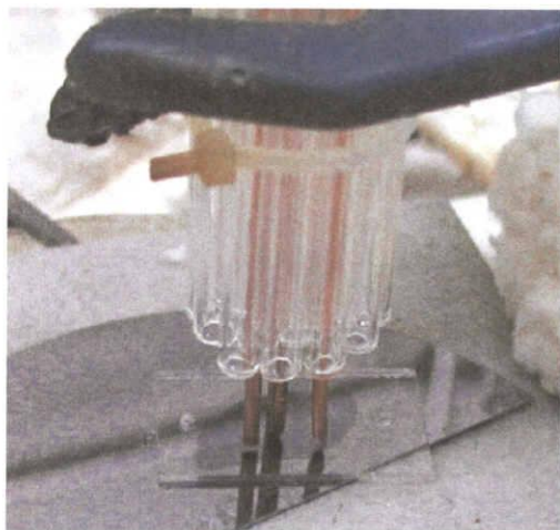
図14 改良した陽極接合装置図
