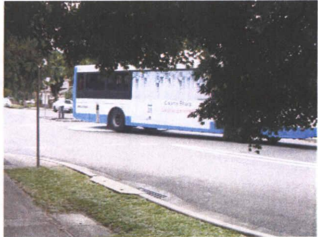
写真 5.6 Mini RA 中央島に乗り上げる大型車 (豪:Ryde)
