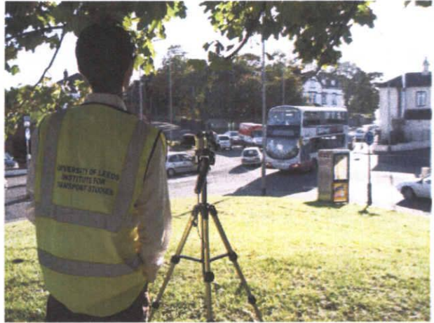
写真 6.2 ビデオカメラの設置状況(イギリス)
