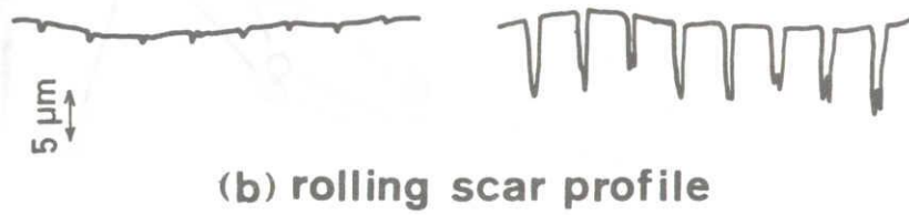
図 6.6 内輪転動面における摩耗痕（大気中、 3 \times 10^6 回）
