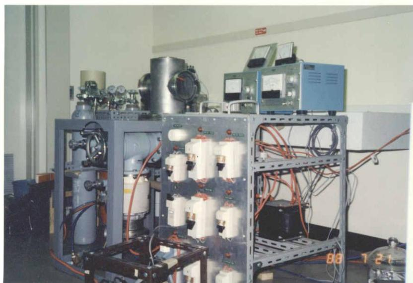
図II-2 本研究で用いたガス蒸発法による微粒子作成装置
