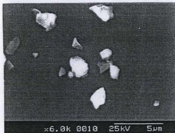
図6.3 WA砥粒 ( 1.2\mu\text{m} )のSEM写真
