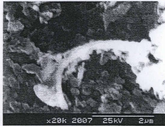
図4.13 研削による切りくずの SEM写真
