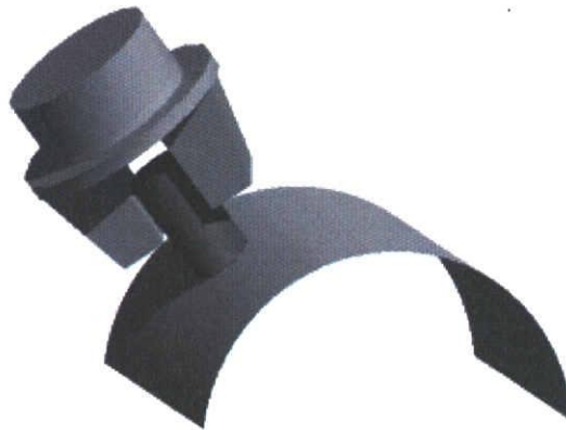
図 4.11: 円筒面の倣い作業
