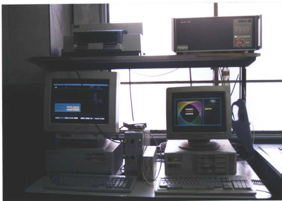
図 5.4 AE 計測システム（日鉄テクノス N.A.I.S.-5000A）
