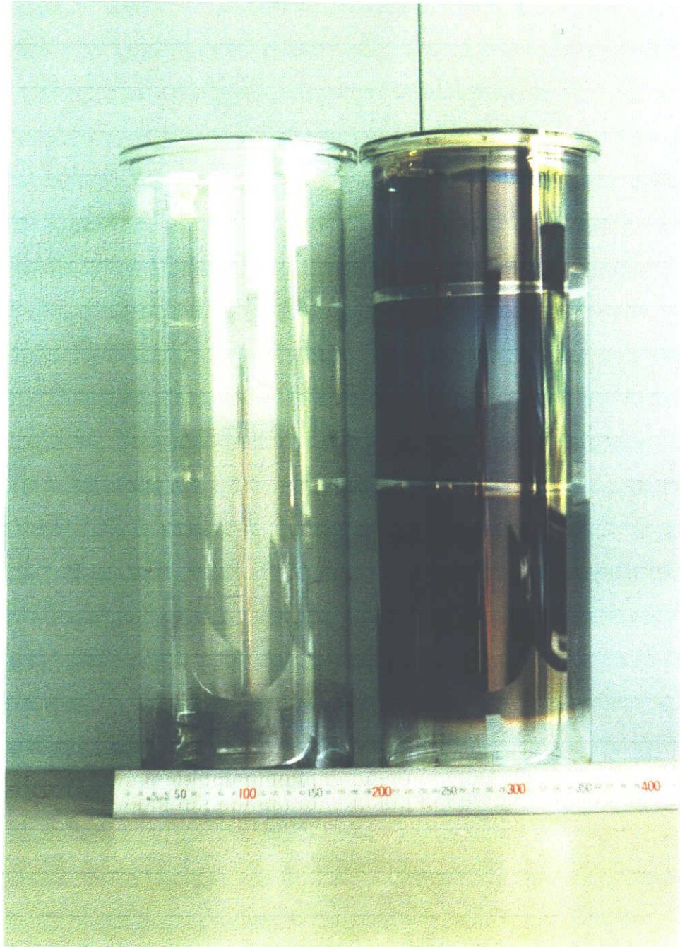
図1.4.3 ガラス製真空容器の外観。 右側： \text{LaB}_x 膜をコーティングした容器。 左側：コーティングしていない容器。
