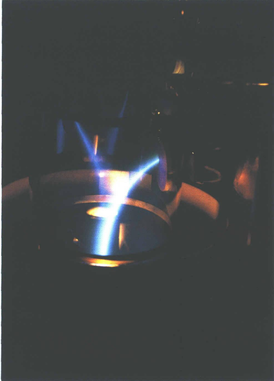
図1.4.2 スパッタリングのためにLaB 6 ターゲットに向かって 曲げられたアルゴンプラズマ柱
