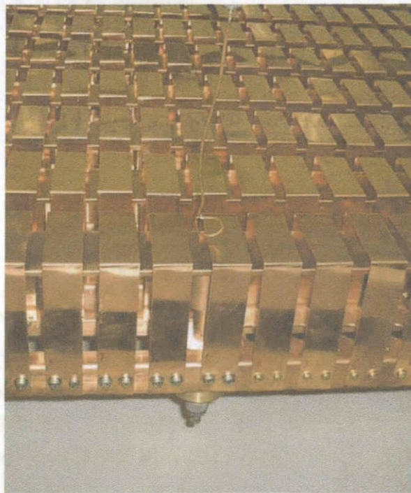
図 3-16 模型アンテナの写真 (a)アンテナ本体、(b)高周波磁気プローブ 模型アンテナは実機アンテナと異なりヘリカル形状でなく直線の形状となっ ている。高周波磁気プローブはセミリジッドケーブルで作成し、プローブの 直径は約 2cm である。
