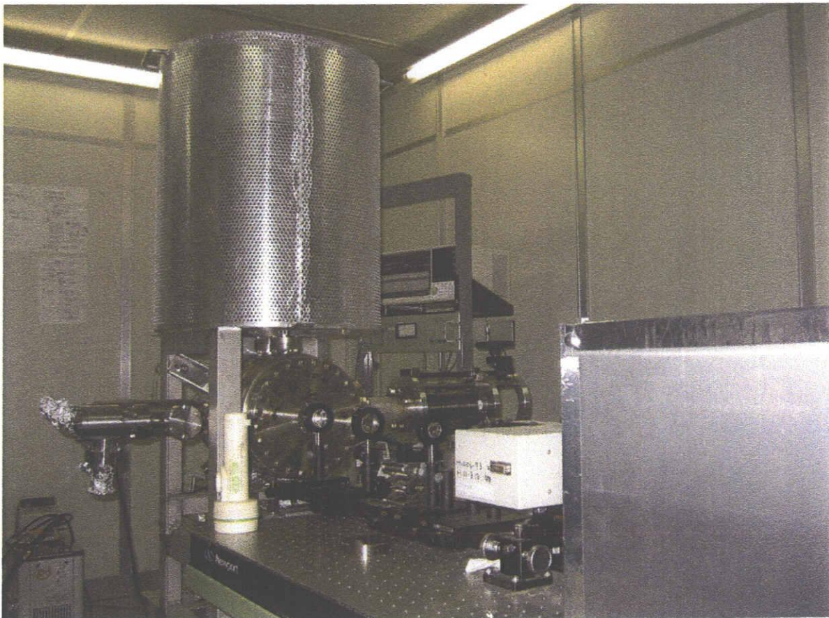
Figure 2.6: 測定中の実験装置全体写真。測定中は電磁シールドやランプシェードをしている。
