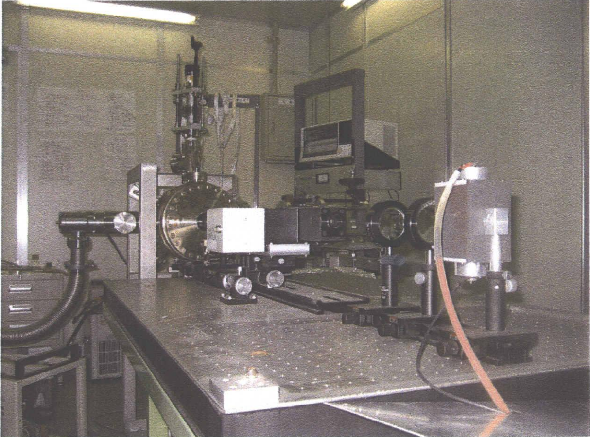
Figure 2.2: 実験装置全体写真。写真手前が光学系。奥に真空チェンバーと計測系が見える。
